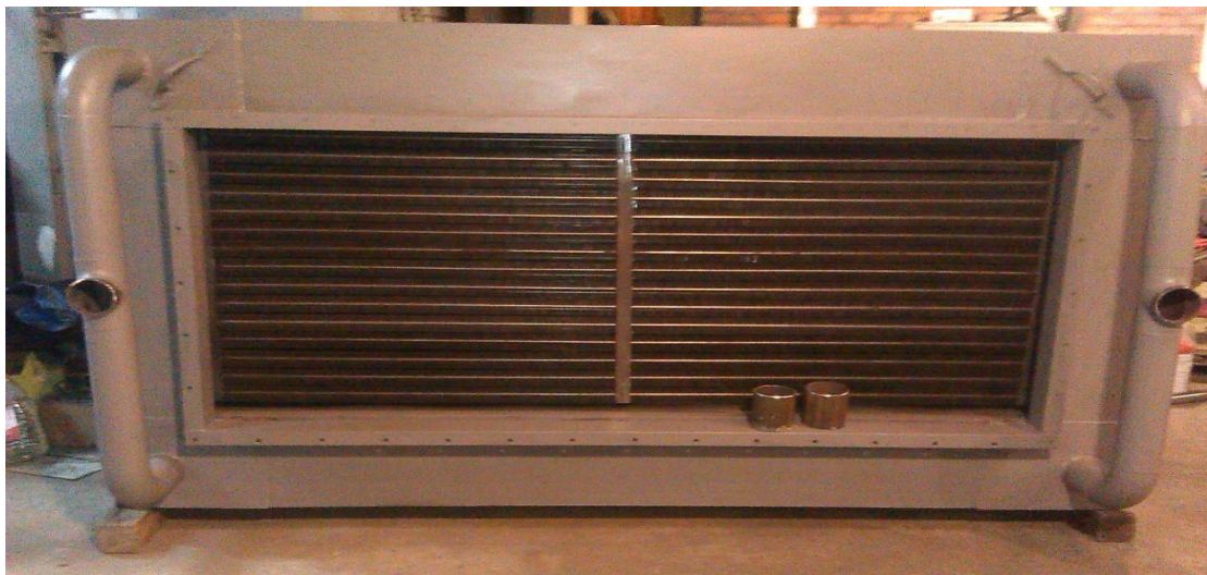
Рис. 3. Загальний вид економайзера для котла ПТВМ-30м
